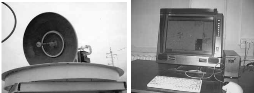
Рис. 9. Метеорологический радиолокатор (поворотная платформа и пульт управления и индикации).
