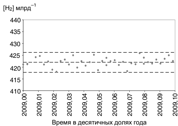
Рис. 3. Результаты ежедневного контроля качества измерений путем измерения концентрации водорода в баллоне с тестовым газом.
