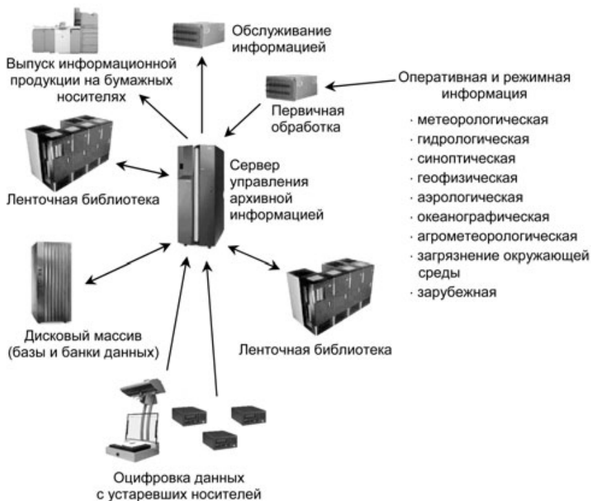
Рис. 1. Структура архивной системы объемом более 4Птб.
