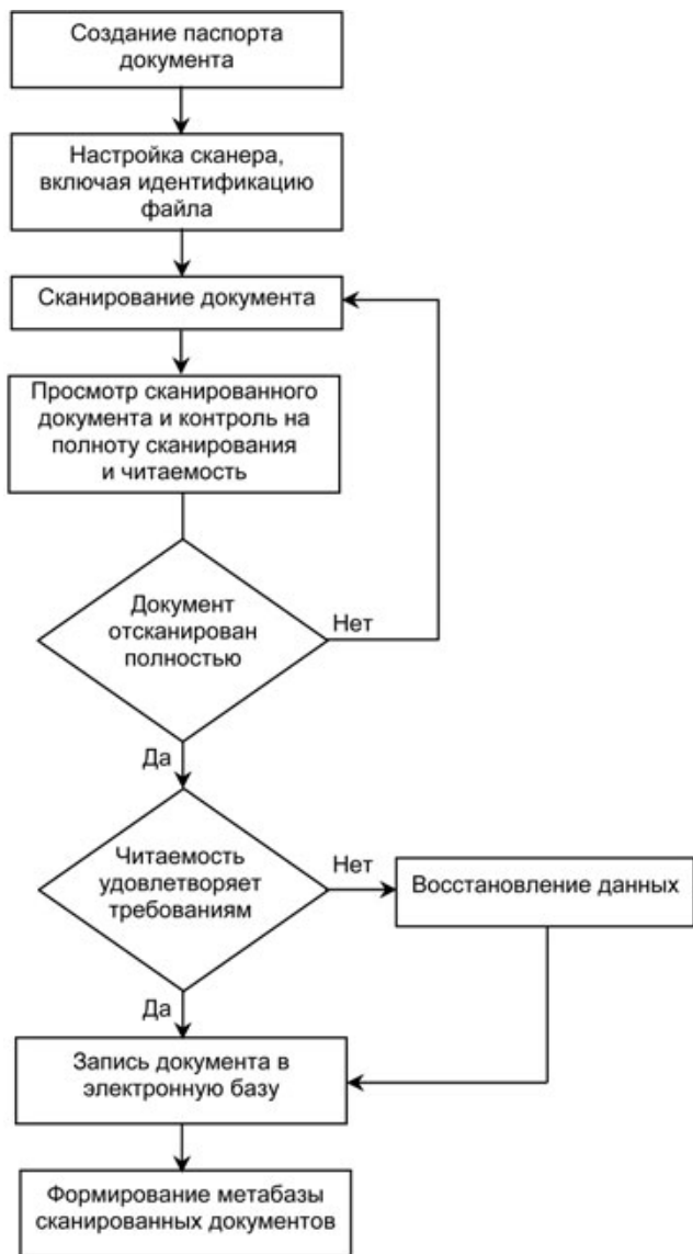
Рис. 1. Схема сканирования информации с листовых материалов.
