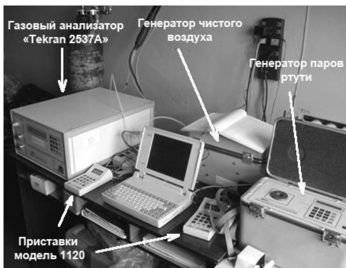
Рис. 1. Комплекс оборудования для автоматического измерения содержания ртути в воздухе, установленный на полярной станции «Амдерма» (Россия); Газовый анализатор «Tekran 2537A» используется для измерения (с ультранизким пределом обнаружения) концентрации газообразной ртути в приземном слое атмосферы.
